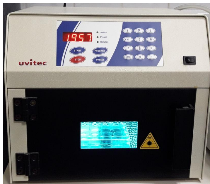
Slika 6. Suspenzija limfocita i puna krv izloženi UVB zračenju od 2 \text{kJ}/\text{m}^2 pomoću uređaja Uvitec Crosslinker CL-E508M (Cambridge, Velika Britanija).
