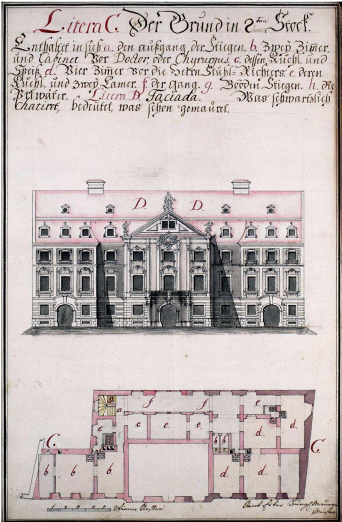
Slika 22. Jakov Erber, tlocrt drugog kata i nacrt pročelja iz 1769. godine
