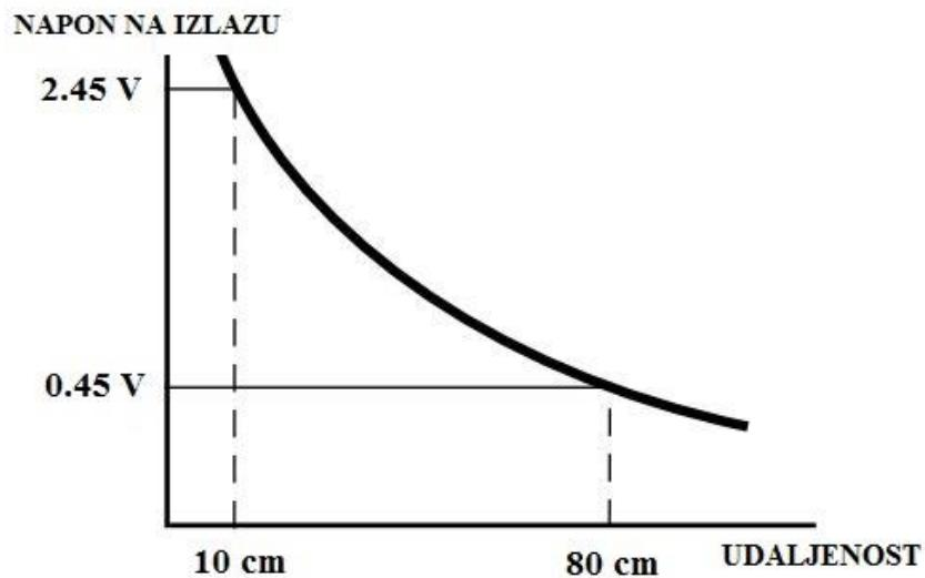
Slika 3.6. Napon na izlazu infracrvenih senzora
