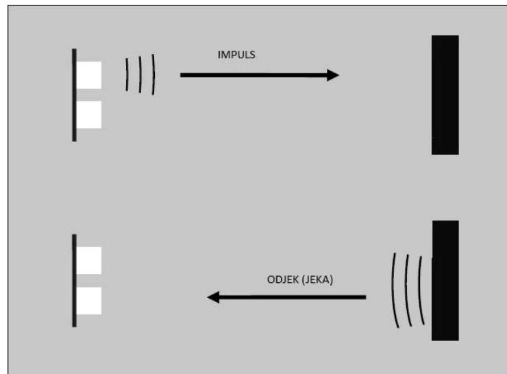
Slika 2.1. Princip rada ultrazvučnih senzora
