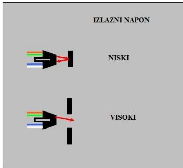
Slika 3.7. Izlazni napon infracrvenih senzora s obzirom na položaj kotača
