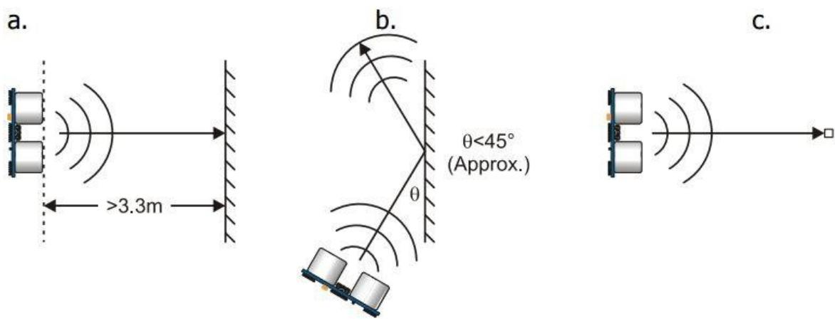
Slika 3.10. Slučajevi nepreciznog mjerena
