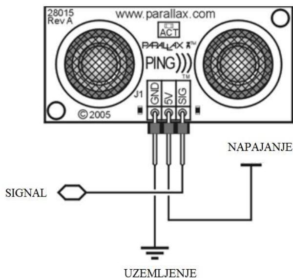
Slika 3.9. Ultrazvučni senzor
