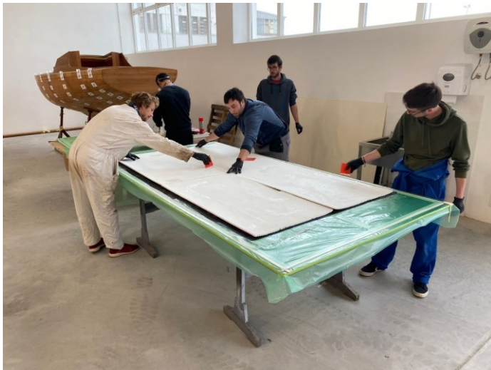
Slika 9 Prikaz procesa vacuum bagging-a
